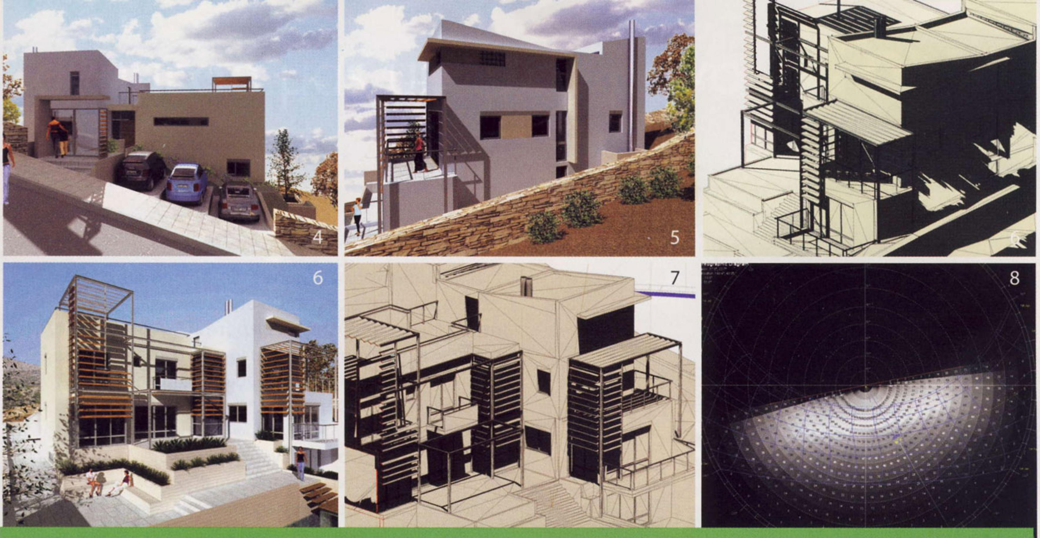
4. Άποψη βόρειας όψης, 5. Άποψη ανατολικής όψης, 6. Σκίαση κτιρίου 15:00, 21 Ιουλίου (ενεργειακό λογισμικό ecotect)
